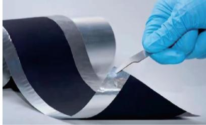
记者12月5日从天津大学获悉,天津大学吉科猛研究员团队联合湖南大学谭勇文教授团队利用钴磷合金,研发出仅用一步即可制成电池电极的电化学腐蚀制备技术。该新技术只需要将钴磷合金放入通电的食盐溶液中进行选择性腐蚀和电位调控氧化,便可一步制得电池电极,整个制备过程不到1个小时,安全绿色且易实现规模化生产。该电极材料不需要像其他电极材料那样需进行配料、匀浆、涂布等繁琐步骤才能用于电池组装,大大简化了电池的制备工序。
