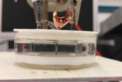
西班牙巴塞罗那自治大学和巴塞罗那材料科学研究所研究人员首次将无线技术引入一种磁性装置。他们将非磁性的氮化钴（CoN）薄膜浸入电解液，通过感应极化，无需连接电线即可控制其磁性。这种范式转变可促进磁性纳米机器人在生物医学和计算系统的应用。在未来的生物医学和计算系统中，基本的信息管理过程或不再需要电线。研究人员表示，通过改变电压来无线控制样品的磁性，代表着这一研究领域的范式转变。
