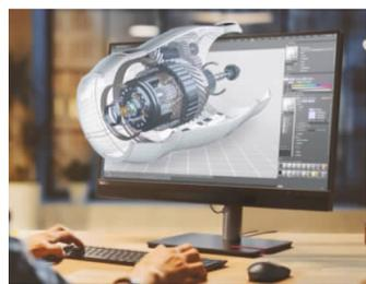
这款显示器将裸眼2D、3D可切换技术应用在显示器领域,主要采用可切换柱状棱镜技术,可实现2D与3D显示自动切换,让用户享受立体真实的沉浸体验。它还具备实时眼球追踪、内置“3D引擎”等技术创新,确保更加自然舒适的视觉体验。
