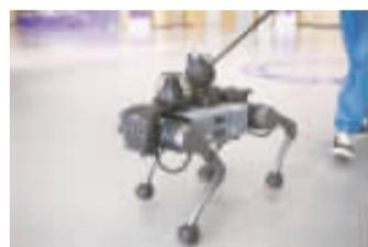
只需牵住“狗绳”,报一声想去的区域,智能电子导盲犬便会缓缓启动,为视障人士带路。除了能导航,智能电子导盲犬集成了激光雷达等多种传感器。利用这些传感器,可以对周围环境进行判断,实现自主避障行走。此外,还能播报路况,“听懂”中英双语指令,自动规划出最优行进路径。
