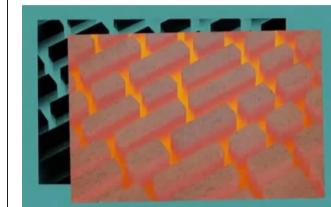
这些“智能砖”充电后能像电池一样储存电能，随时准备为其他装置供电。它是利用砖的多孔结构，使用气相沉积技术为整块砖添加了一层导电聚合物，让砖变成一个储能电极。砖本身的红色色素——氧化铁（铁锈），对于诱发聚合反应来说十分关键。
