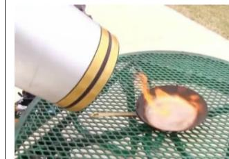
这款手提式声波灭火装置能发出30至60赫兹的低频声波，在短短几秒钟内将火扑灭。声波灭火装置由一个声频发生器、放大器、用硬纸管做成的准直器（让声波集中在特定方向）组成。利用声波来代替助燃氧气，以某种频率，声波成功地将“氧气”与燃料分离开来。这样就产生了足够的空间来阻止着火。
