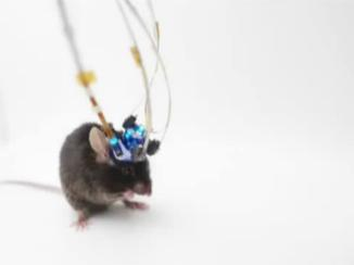
记者2月29日获悉，中国科学技术大学、中国科学院深圳先进技术研究院和深圳理工大学（筹）的研究团队合作，开发出目前世界上最轻的超紧凑头戴式荧光显微镜TINIscope。
