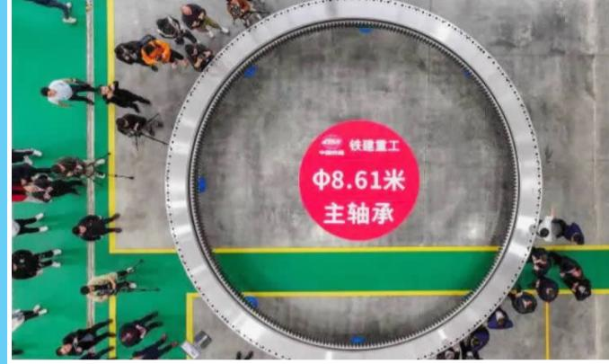
近日，在湖南长沙的中国铁建重工集团股份有限公司（以下简称铁建重工）第二产业园，一间代号为“197”的厂房里，直径从3米至8.6米的多个“大铁环”正被加工制造中。这些“大铁环”叫主轴承，是盾构机的“心脏”部件。它是盾构机在服役期间唯一不能更换的部件，需要直面盾构机超重载、大偏载、频变载等极端恶劣工况考验。主轴承成型后，一旦损坏，上亿元的盾构机将面临报废的危险，整个工程的成本也将成倍增长。
