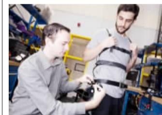
这款控制机器人外骨骼，无需专门训练、特别校准，对复杂算法进行调整后，用户穿上外骨骼就可以直接行走。新系统使用深度学习自动调整外骨骼为人类提供帮助的方式，现已证明这种外骨骼可顺利地支持行走、站立以及爬楼梯或坡道等动作。
