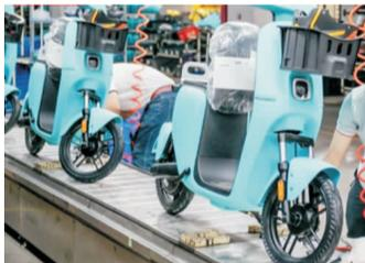
这款产品整体构造与传统两轮电动车相似,车身尺寸为1570mm×630mm×1050mm,整车重量控制在55公斤以下。其续航里程达到了100公里,采用了氢能源作为动力来源。在供电设计上,该车还搭载了额定功率为350W的混动电源磷酸铁锂电池。
