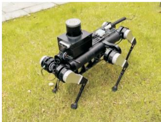
这款导盲机器人具备先进的视觉环境感知功能,能够自主导航至目的地,动态躲避障碍,甚至能识别红绿灯。该机器人能够根据盲人的语音指令快速响应,目前语音识别准确率高达90%以上,通过语音交互,可以实时反馈行走和环境状况等信息,实现双向智能交互。
