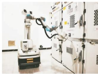
这款产品集成了先进的智能感知、图像识别和高精度机械臂技术,具备自主导航、红外测温 and 开关柜局放检测、倒闸操作、自主紧急分闸等功能,可代替人工完成“自动巡检+倒闸操作”一体化作业。通过电脑发出指令,它就将手车开关由试验位置摇至工作位置。
