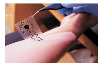
这款柔软且有弹性的电子设备，佩戴在皮肤上时能模拟皮肤上感受到的压力或振动。设备由一个柔软且可拉伸的电极连接到硅胶贴片上组成，可以像贴纸一样贴在指尖或前臂上，与皮肤直接接触的电极通过导线与外部电源相连。通过向皮肤发送温和的电流，它可以根据信号的频率产生压力或振动的感觉。
