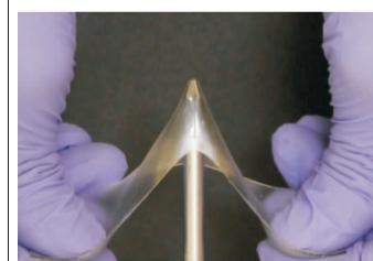
这种名为“玻璃凝胶”的新材料含有超过50%的液体，非常坚硬而且难以破碎。玻璃凝胶结合了玻璃和凝胶两种材料的特性，一个关键特性在于它们50%以上是液体，这使得它们比物理特性类似的普通塑料能更有效地导电。它们也不会蒸发或变干燥。此外，玻璃凝胶表面具有很强的黏附性，这对于硬质材料来说是不寻常的特性。（本报综合）
